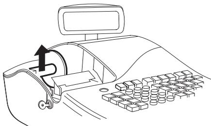
3. Die Abdeckung des Batteriefachs entfernen. Dazu auf den Pfeil drücken, der auf dieser aufgeprägt ist, und die Abdeckung nach oben schieben, wie in der Abbildung gezeigt.
